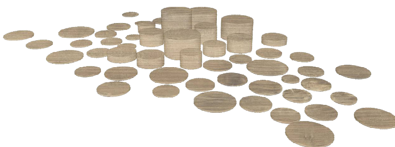
Ryc. 16. Nawierzchnia drewniana z pniakami drewnianymi.
