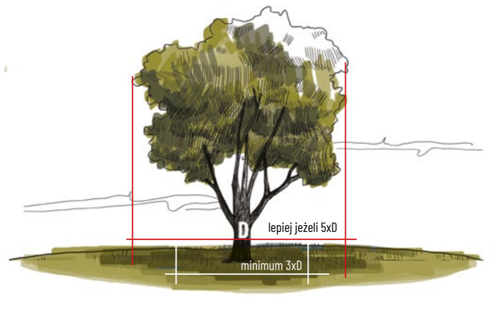
Rys. 4. Minimalna odległość cięcia korzeni ze względu na statykę drzewa od pobocznic pnia; promień systemu korzeniowego to nawet 2- lub 3-krotność promienia korony (Smiley 2008, rys. Agnieszka Bocheńska-Niemiec)
